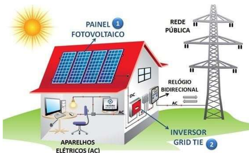
Figura 2 - Funcionamento de sistema fotovoltaico conectado à rede
